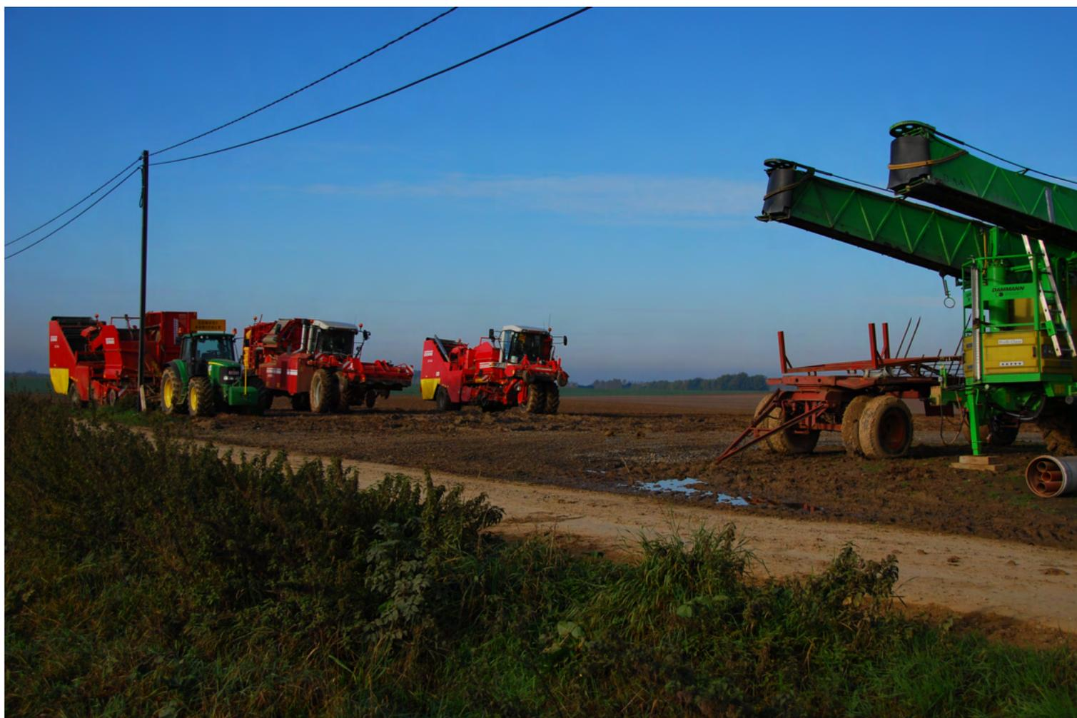
Le tracteur agricole possède classiquement quatre roues, les roues arrière sont motrices et de plus grand diamètre que les roues avant directrices. Les tracteurs à deux roues motrices sont de plus en plus rares. En effet, les agriculteurs utilisent des tracteurs de plus en plus puissants demandant plus d'adhérence. Depuis la fin des années 1980, l'apparition de l'électronique embarquée a permis de développer des « aides à la conduite ».
